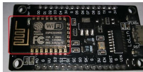
Gambar 1. Bentuk fisik NodeMcu
